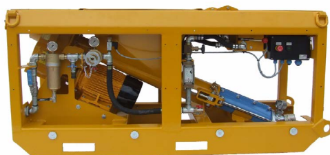
Rys. 18. Agregat pompująco-mieszający typu PuMa M (mat. P.W. ADIBUT 2017)
